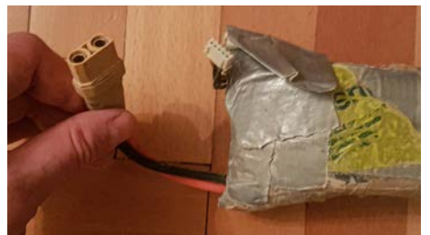
Slika 4: Baterija, ki se lahko priklapi na Malo vrtalko.
