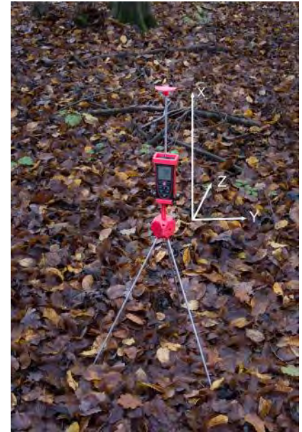
Slika 1. DistoX na pripomočku za umerjanje v svojem naravnem okolju. Koordinatni sistem je prerisan s slike v delu [4]. Foto: Matija Perne
