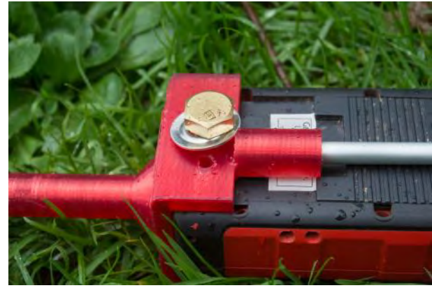
Slika 3. Pritrditev DistoX na pripomoček za umerjanje po izdelavi skoraj čisto pravega vijaka. Bil je nekoliko predolg, kar sem rešil z aluminijasto podložko namesto, da bi ga žagal, preveliko luknjo na pripomočku za umerjanje pa sem zmanjšal z nekaj plastmi laka za nohte. Foto: Matija Perne
