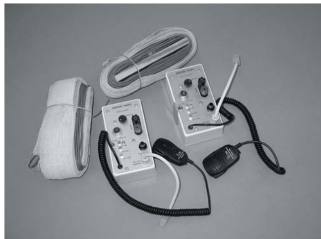
Slika 1: Sistem za brezžično komunikacijo sestavljata dva identična aparata s priključnima dipolnima antenama, narejenima iz traku električnega pastirja in nerjaveče jeklene izolirane žice. (foto: Ivo Sedmak)
