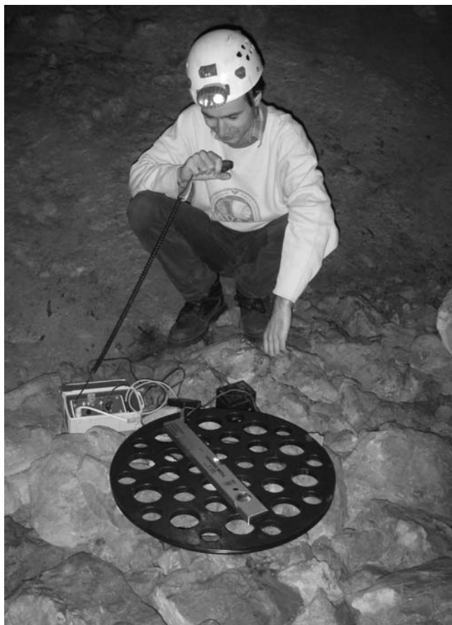
Slika 6: Operater v jami z oddajno tuljavo. Oddajna tuljava mora biti položena povsem horizontalno, zato je najbolje, da jo poravnamo z "vaservago". Vaservago med oddajanjem seveda umaknemo s tuljave. (foto: Matej Dular)
